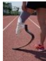
3Dプリンターにより造型した 陸上競技用下腿義足 (東大山中研究室)
